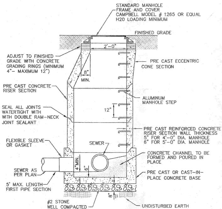
**6 TYPICAL SANITARY SEWER MANHOLE**
