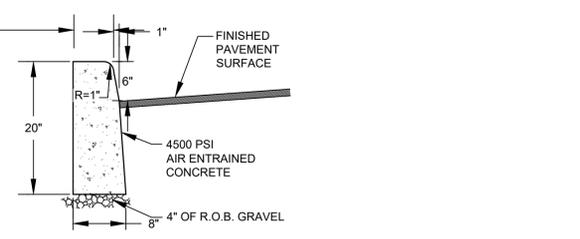
CONTRACTOR TO PROVIDE 1/2" PREFORMED BITUMINOUS - IMPREGNATED FIBER JOINT FILLER EVERY 10'. JOINT FILLER TO COMPLY WITH A.A.S.H.O. SPEC. M-213. FILLER TO BE RECESSED IN FROM FRONT FACE AND TOP OF CURB 1/2".
