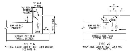
**CAST-IN-PLACE CONCRETE CURB**
