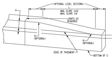
**CAST-IN-PLACE CONCRETE CURB TRANSITIONS**
